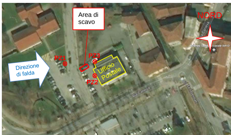
Figura 17: posizionamento piezometri di progetto.
